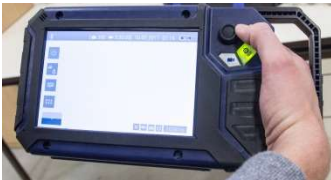
Fig. 15: Lorsque la poignée est déployée, le moniteur peut être tenu et actionné d'une seule main.
