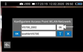
Fig. 62: Canal WLAN marqué d'une flèche
