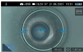
Fig. 45: Triangle d'avertissement sous l'affichage de la distance
