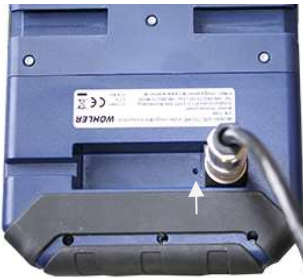
Fig. 70: Ouverture Reset, marqué par une flèche
