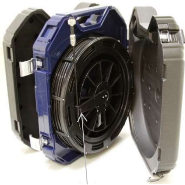
Fig. 83: Extrémité du jonc dans la position finale
