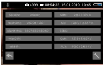
Fig. 53: Menu d'informations avec SOM (micro logiciel de la caméra) et CAM (version de la tête de caméra)
