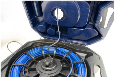
Abb. 61: Falsch: Kamerakabel nicht straff gezogen
