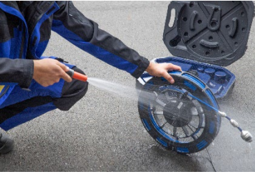
Abb. 58: Abspritzen von Haspel und Stange
