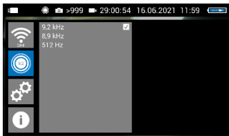
Abb. 33: Ortungssender mit 9,2 kHz Sendefrequenz ausgewählt
