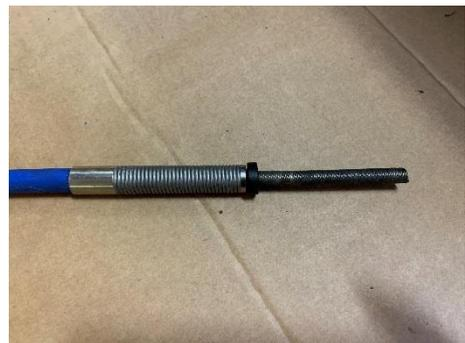
Antriebswelle nun bündig aus Schutzmantel (Hülse mit Leitspirale) herausziehen.
