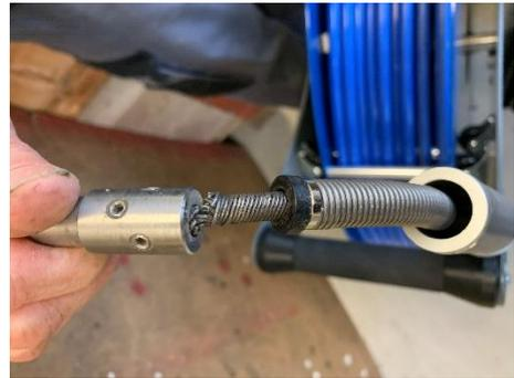
2. Beschädigte Reinigungswelle komplett abrollen und möglichst gerade auslegen am Boden.
