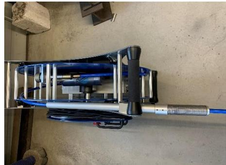
3. Bürstenanschluss an der Spitze demontieren.
