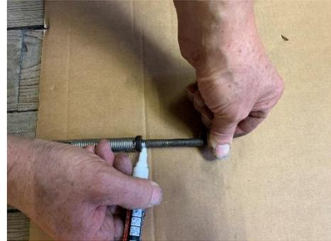
Reinigungswelle bei der Markierung mit einem Winkelschleifer abschneiden und die Kante an der Schnittstelle sauber anschleifen.
