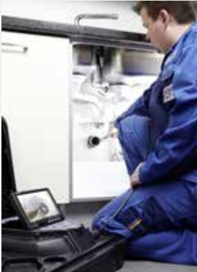
La tête de caméra d'un diamètre de 26 mm, résistante et étanche jusqu'à 3 bars, permet une inspection visuelle et le passage de coudes à 87° dans des conduits à partir d'un diamètre 40 mm.
