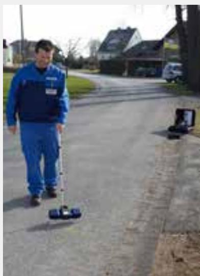
La localisation exacte par ondes radios permet de repérer à travers le béton et l'asphalte la tête de caméra. Cela permet de gagner beaucoup de temps et d'éviter ainsi la détérioration des constructions.
