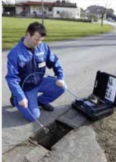
La tête de caméra couleur rotative à 360° et pivotante à 180° permet de ne pas rater le moindre détail lors de vos inspections.
