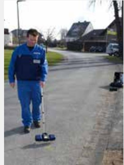
La localisation exacte par ondes radios permet de repérer à travers le béton et l'asphalte la tête de caméra Wöhler VIS 350, ainsi gagner un temps précieux et ainsi, d'éviter la détérioration des constructions.
