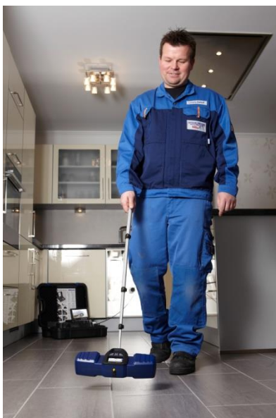
Fig. 36: Localizzazione della testata VIS nel pavimento
