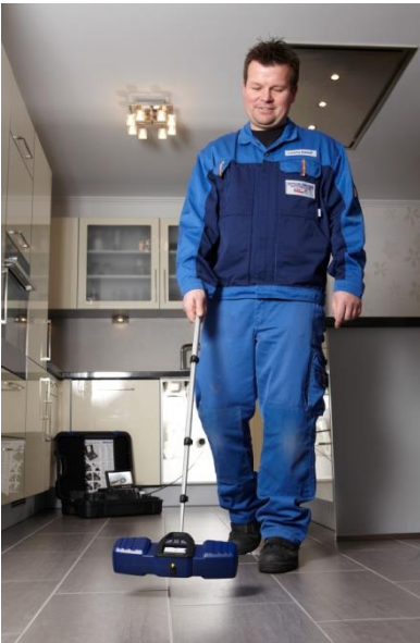
Abb. 5: Lokalisierung des Kamerakopfes im Boden
