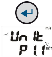
Abb. 16: Einstellungsmodus – Auswahl der Messeinheit
