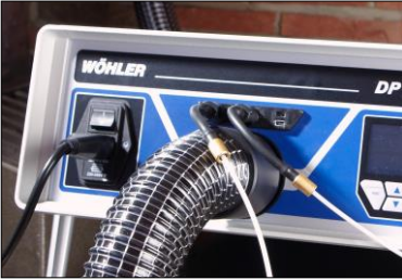
Abb. 37: Anschluss der Kapillarschläuche zur Differenzdruckmessung
