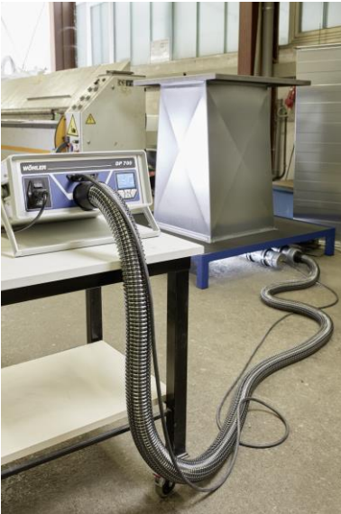
Abb. 12: Beispiel Messaufbau für Messung nach DIN 15727
