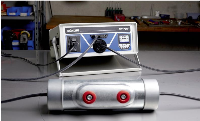
**Dichtheitstest an einer einzelnen Komponente**
