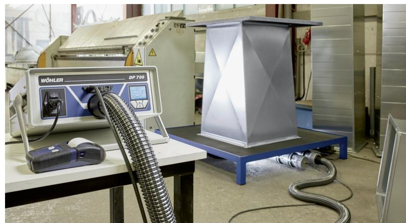
**Dichtheitstest in einer Serienfertigung an einer eckigen Luftleitung. Der Prüfstand kann einfach und schnell vom Luftleitungshersteller in Eigenregie in seiner Fertigung aufgebaut werden. Diese Methode ist bei bei runden, ovalen und eckigen Bauteilen einsetzbar. Selbst komplexe Bauteile können geprüft werden, wenn sie standfest auf der Bodenplatte stehen oder fixiert werden.**
