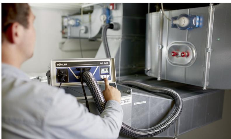
**Wöhler DP 700, Dichtheitsprüfgerät für RLT- und KWL-Anlagen sowie einzelnen Komponenten**
