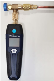
Abb. 13: Wöhler SC 660 an Kälteanlage angeschlossen
