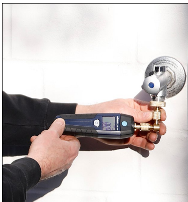
Figura 4: Anschluss mit Winkeladapter 90° (Art. Nr. 8841) und Messadapter (Art. Nr. 8856)
