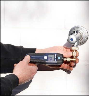
Abb. 5: Anschluss mit Winkeladapter 90° (Art. Nr. 8841) und Messadapter (Art. Nr. 8856)
