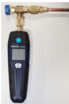
Figura 12: Wöhler SC 660 collegato all'impianto frigorifero
