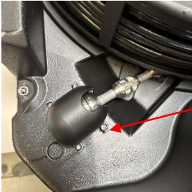
Abb. 26: Aufsetzen der Transportsicherung
