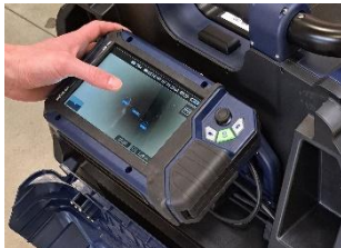
Abb. 72: Start und Endpunkt der Messstrecke festlegen.
