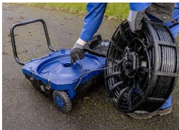
Abb. 16: Anschlusskabel durch die Öffnung der Haspelaufnahme ziehen
