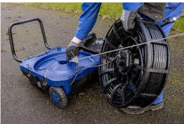
Abb. 96: Anschlusskabel durch die Öffnung der Haspelaufnahme ziehen
