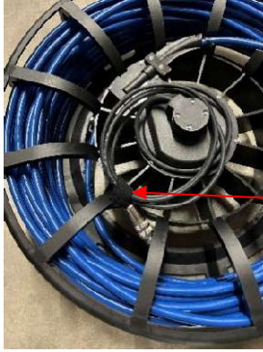
Fig. 14 : Bande velcro sur le câble du moniteur
