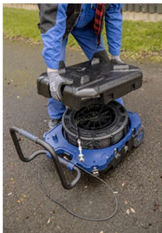
Fig. 104 : Retirer la coque inférieure
