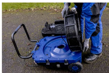
Fig. 111 : Placer le dévidoir dans son panier
