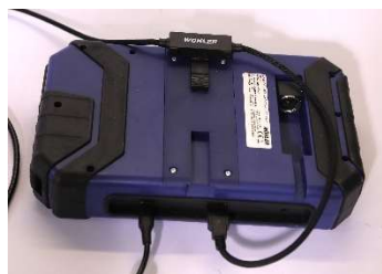
Fig. 29: Adaptateur pour sondes VE sur le moniteur
