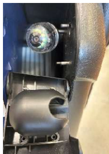
Fig. 23 : La sécurité de transport peut être déposée dans la trappe de la caméra.
