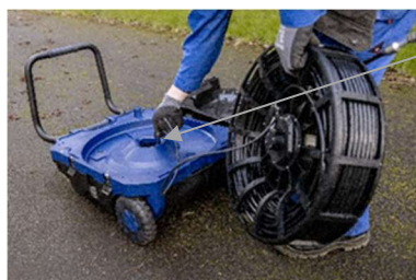
Fig. 110 : Tirer le câble de raccordement à travers l'ouverture du panier du dévidoir
