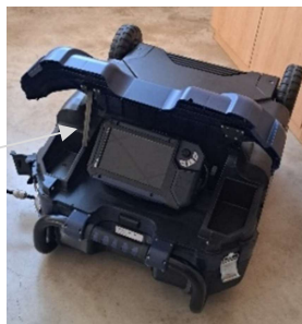
Fig. 47 : Caméra d'inspection HD Wöhler VIS 750 en position couchée avec protection anti-éblouissement
