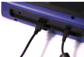
Fig. 30: Câble USB-A connecté au moniteur
