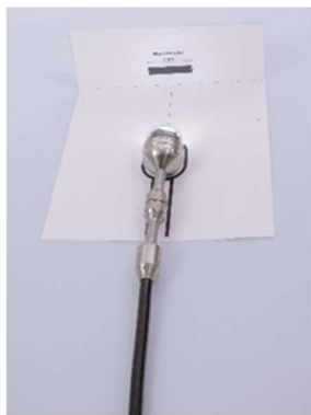
Fig. 83 : Étalonnage avec modèle d'étalonnage
