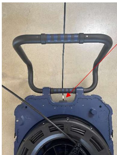
Fig. 113 : Positionnement correct du dévidoir
