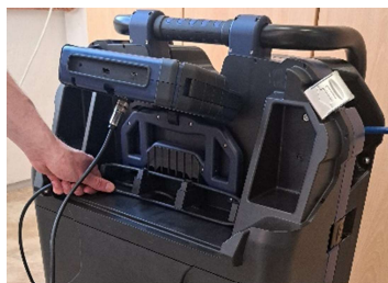
Fig. 115 : Enrouler le câble du moniteur autour des dômes de câbles
