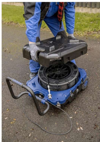
Fig. 114 : Poser la coque inférieure
