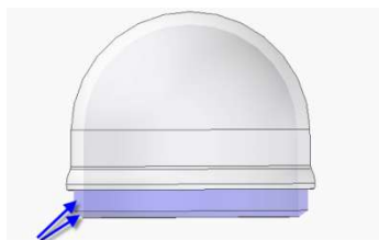
Fig. 99 : Installation de la coupole de la tête de caméra
