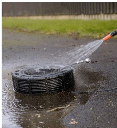
Fig. 107 : Lavage au jet du dévidoir et de la tige
