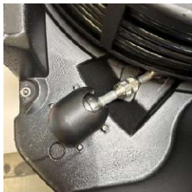
Fig. 26 : Mise en place du dispositif de sécurité de transport
