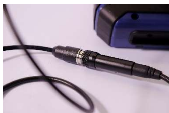
Fig. 31: Connecteur circulaire sur le raccord de la sonde
