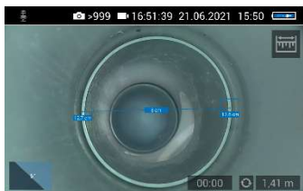
Fig. 79 : Affichage de la distance entre deux points de mesure
