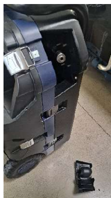
Fig. 24 : Trappe amovible de la caméra
