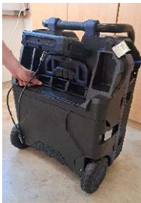
Fig. 44 : Enrouler le câble de connexion avant de remettre le moniteur dans le trolley
