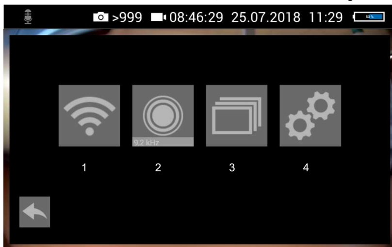
Fig. 66 : Menu système avec les sous-menus WiFi (1), Localisation (2), Galerie d'images et de vidéos (3) et Menu paramètres (4)
