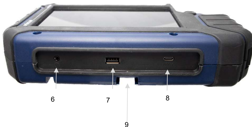
Fig. 9 : Dessous du moniteur avec panneau de connexion
