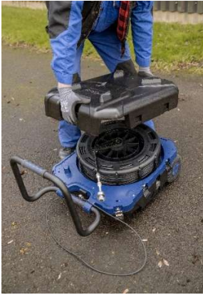
Fig. 19: Placer la coque inférieure
