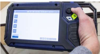
Fig. 45 : Lorsque la poignée est sortie, le moniteur peut être tenu et utilisé d'une seule main.
