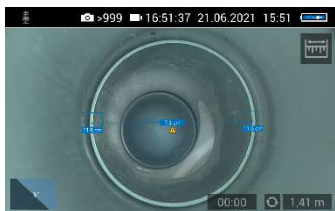
Fig. 80 : Triangle d'avertissement en dessous de la distance mesurée
