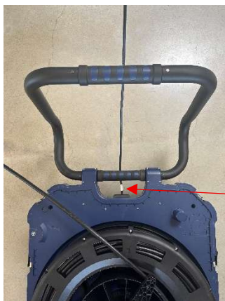
Fig. 18: Position correcte du dévidoir
