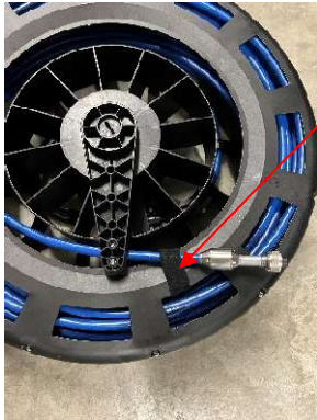
Fig. 15 : Bande velcro à l'extrémité de la tige
