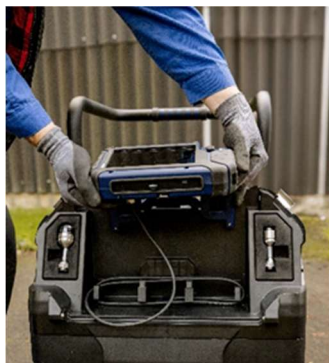
Fig. 101 : Tirer le moniteur vers le haut pour le retirer de son support avec son pied.
