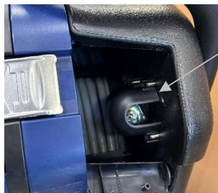
Fig. 22 : Sécurité de transport sur la tête de caméra
