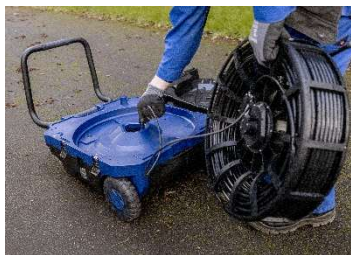
Fig. 16: Faites passer le câble de raccordement à travers l'ouverture du support du dévidoir.
