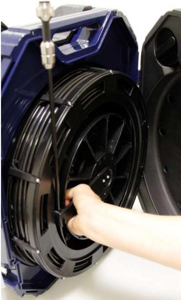
Abb. 72: Stangenauslauf und Haspel greifen
