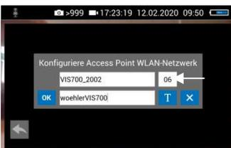
Abb. 61: WLAN-Kanal mit Pfeil markiert
