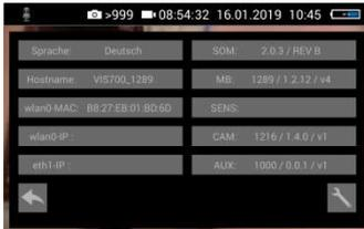
Abb. 52: Infomenü mit SOM (Firmware der Kamera) und CAM (Version des Kamerakopfes)
