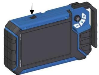
Abb. 16: Druckknopf zum Ausziehen des Handgriffs mit Pfeil markiert
