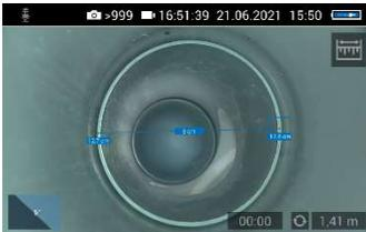
Abb. 43: Anzeige der Distanz zwischen zwei Messpunkten
