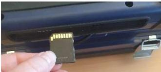
Abb. 9: SD-Karte korrekt einführen
