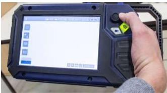
Abb. 15: Ist der Handgriff ausgezogen, kann der Monitor mit einer Hand gehalten und bedient werden.
