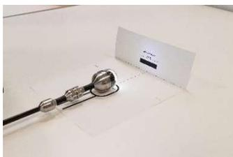
Abb. 47: Kalibrieren mit Kalibriervorlage
