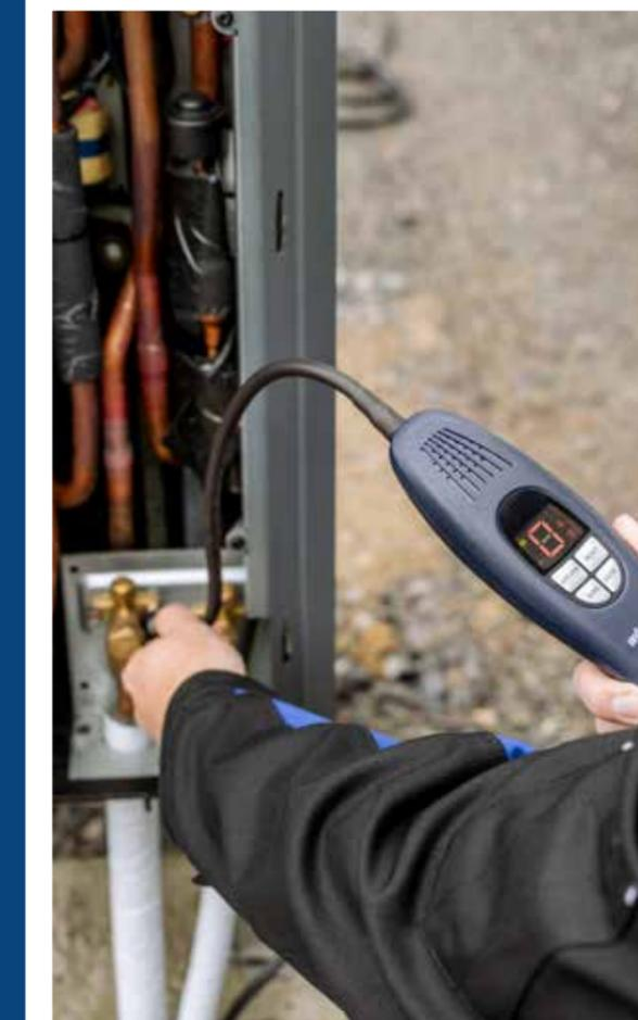
Détection précise de tous fluides frigorigènes courants et azote hydrogéné.
